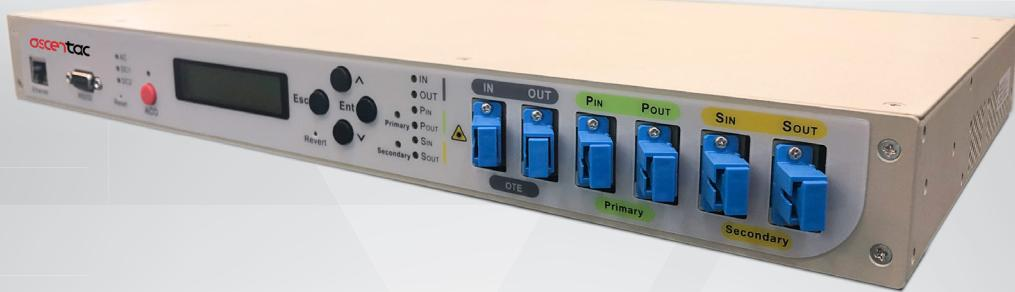
Ascentac OPS3000 系列為標準 1U 單機型光保護開關，提供 1:1 含備芯監測。當系統偵測到路由斷線，此產品可自動且即刻將光纖路由主要線路切換至備用線路，使通訊立刻恢復，有效節省人工查測及切換之時間。
