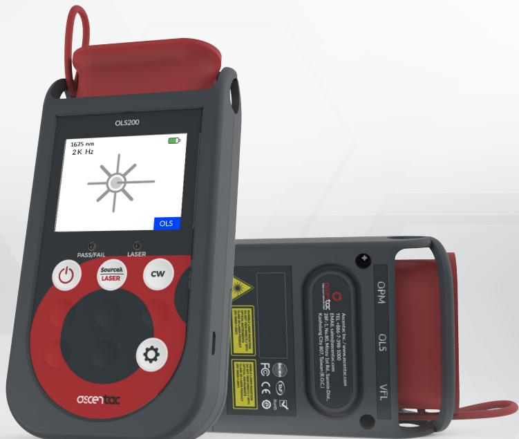
Ascentac OLS200 系列為光源，可穩定輸出光源。提供 850、1300、1310、1490、1550 及 1625nm 六種校正波長，用戶可選兩種，波長穩定性佳。此光源可以連續波、270Hz、1kHz 或 2kHz 之形式輸出。
